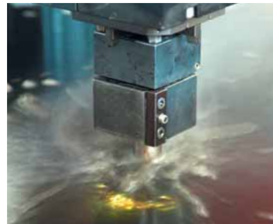
Die Funken fliegen. Eine Senkerodiermaschine im Einsatz.
