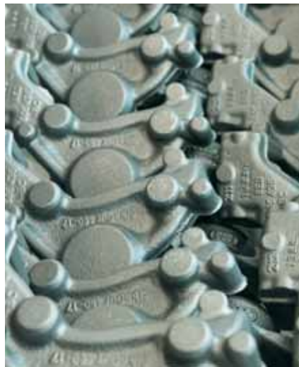
Versandbereit: Gussteile aus Sibodur für das Fahrwerk von Personenzügen.
